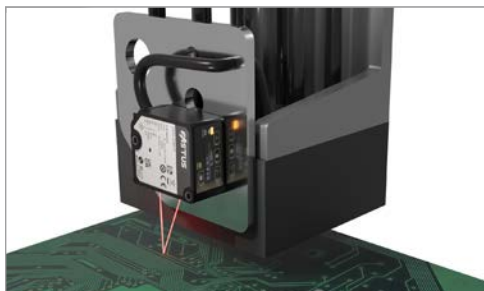
安装部件高度检测
